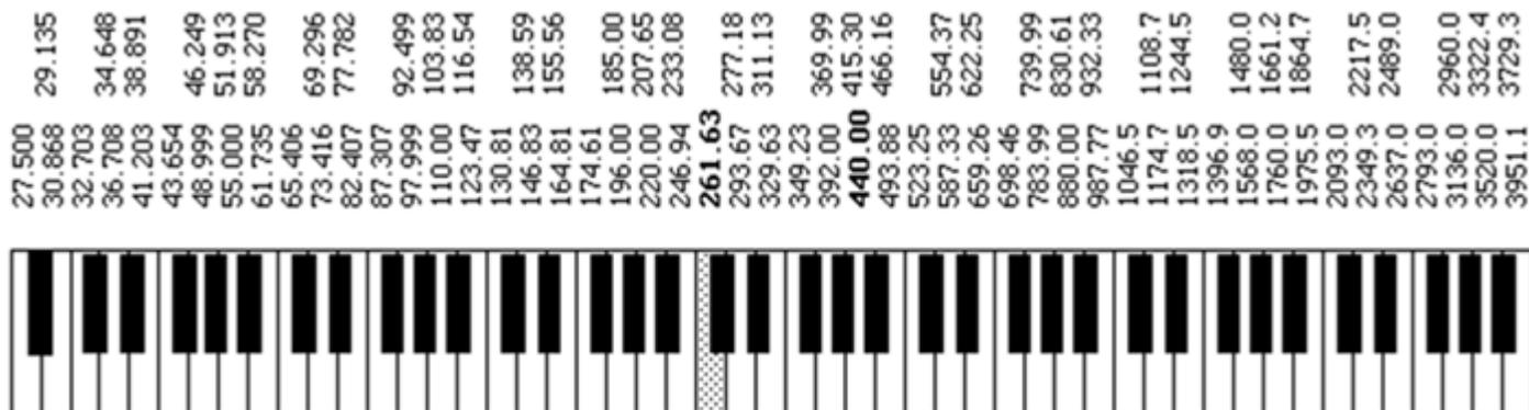
图 8-25 电子琴音阶基频对照图 (单位 Hz)
